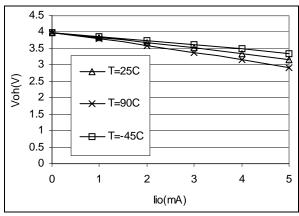
Figure 87. Typ. V<sub>OH</sub> at V<sub>DD</sub>=5V
