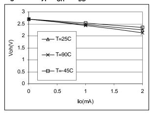
Figure 86. Typ. V<sub>OH</sub> at V<sub>DD</sub>=3V
