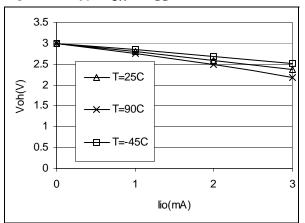
Figure 85. Typ. V<sub>OH</sub> at V<sub>DD</sub>=4V
