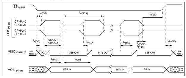
Figure 95. SPI Master Timing Diagram 1)
