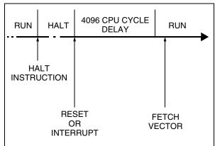
Figure 26. HALT Mode Flowchart
